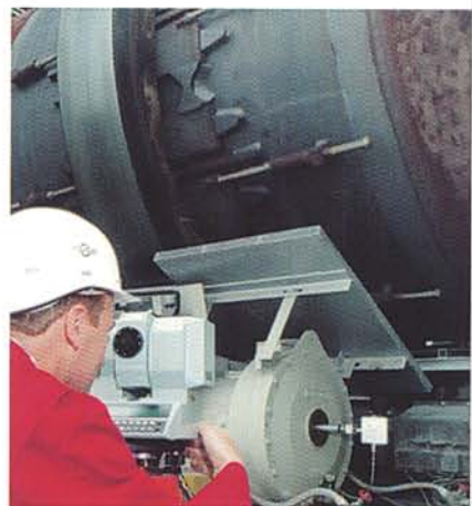
Mesure POLSCAN® d'un four rotatif.
