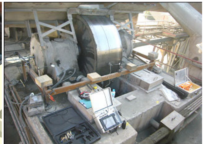
Flexion alternée du galet (Pesée chaude) due à la charge tournante (vilebrequin)
