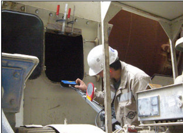
Faux rond de la couronne et conséquence sur le jeu à fond de dent
