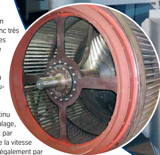
Rotor entièrement assemblé d'un séparateur SEPOL®-SV.
